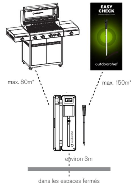
Pour une bonne connexion sans fil et sans interruption, nous recommandons une distance d'environ 50m\* entre le Repeater et la sonde, et une distance d'environ 90m\* entre le téléphone portable et le Repeater.
