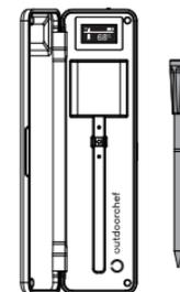
Retirez la sonde de la station de charge pour démarrer l'appareil
